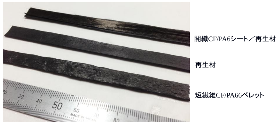
図 3.15 再生材および未使用材を用いた複合押出し成形例
