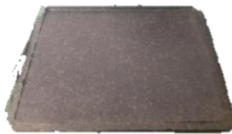
図 3.10 再生材シートの成形例
