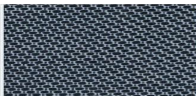
図 2.2 織物 CF/PPS 樹脂積層板の表面像
