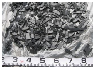
図 3.7 二軸式破碎機による破碎実験後の状況 (織物 CF/PA66 積層板 (W620×L800×t3mm))
