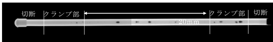
図 2.24(a) 疲労曲げ疲労試験に使用した試験片
