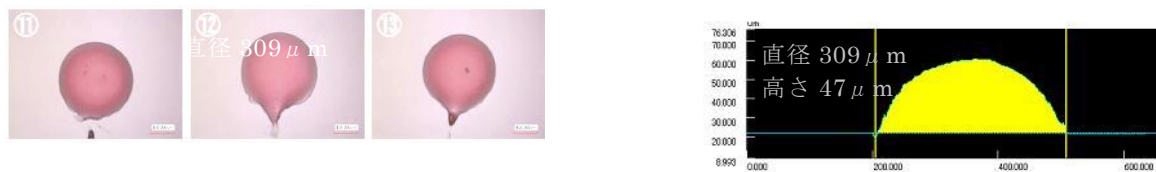
図 2.31 0.06mm ニードルを用いた点塗布と断面形状
