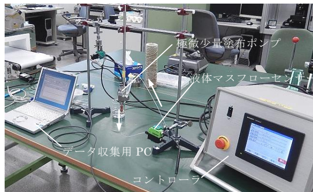
図 2.27 精密流量計測システム
