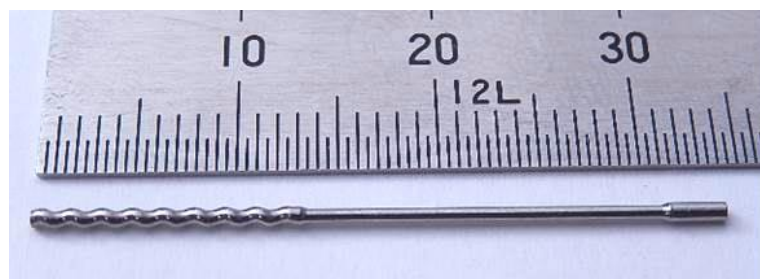
図 2.20 極微量塗布ポンプ用ローター試作品
