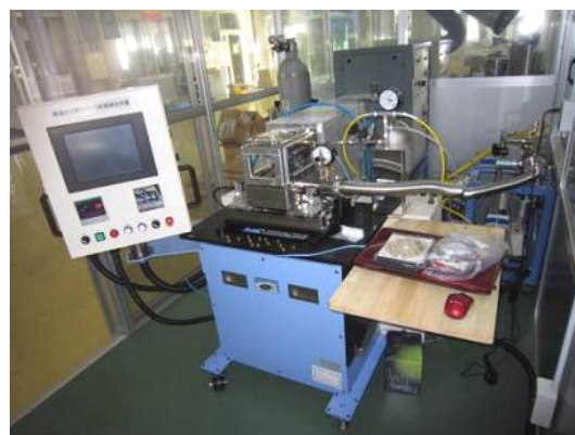
図 2.10 溶湯加圧熱サイクル制御鋳造 装置の全景
