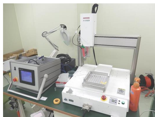
図 2.29 卓上型ロボット塗布システム
