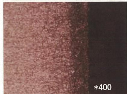
Photo 2 4. 12%拡散窒化溶融塩融合処理
