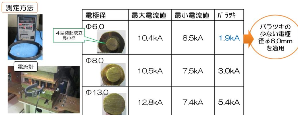
図 2-2-5 適正な電極径の選定
