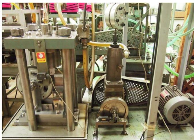
図 2-3-22 曲げ疲労試験機
