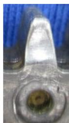
図 2-3-4 試験結果(飛込み歯面)
