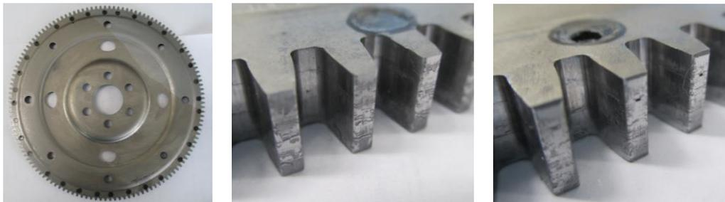
図 2-2-9 シェーピング試作型4、5加工品
