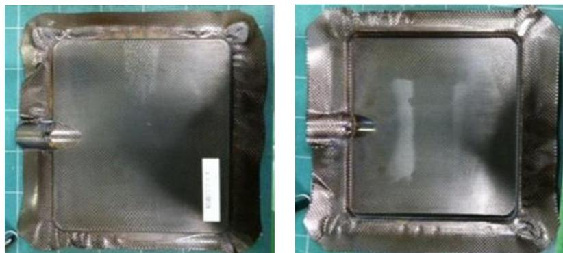
図 10 スタンパブルシートから成形した車両部品成形品
