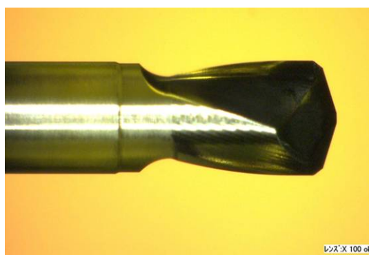
図 3.12 \phi 1.0 mm2枚2段刃
