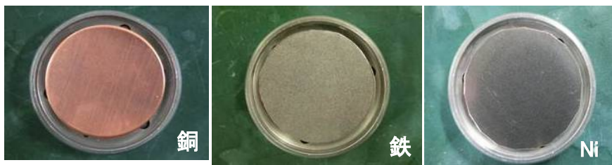
図 3.2 研磨定盤(直径は 25 mm)
