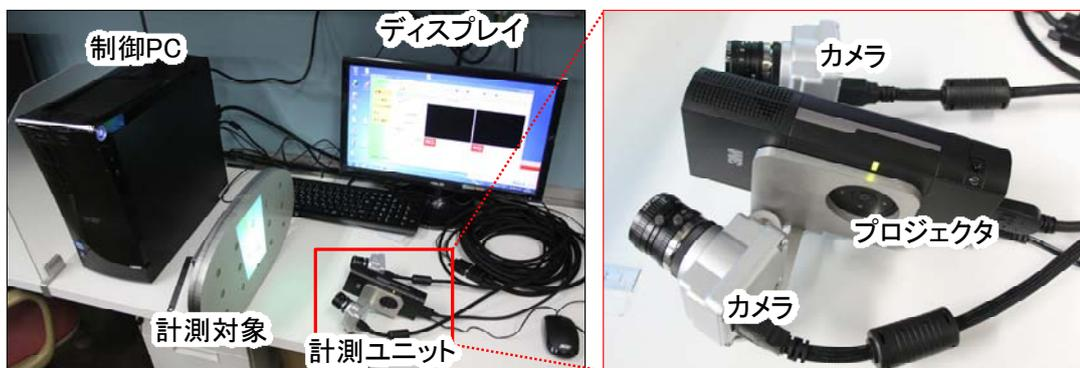
図2-1 ロボット搭載用投影式三次元計測ユニットの外観
