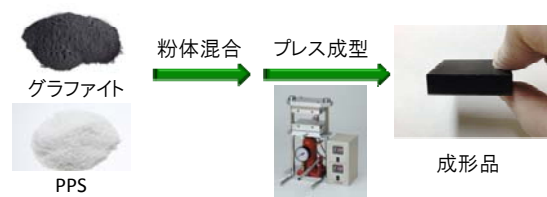
図 2-6-1 溶融混合法および粉体混合法による成形品の作製
