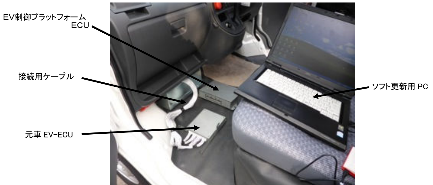
図2-3 EV車両搭載ECU（EV制御プラットフォームに切り換え走行テスト） また車体ナンバーを取得し、一般公道での走行試験も実施している。
