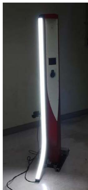
図 2.2.3 走査式広視野外観検査装置
