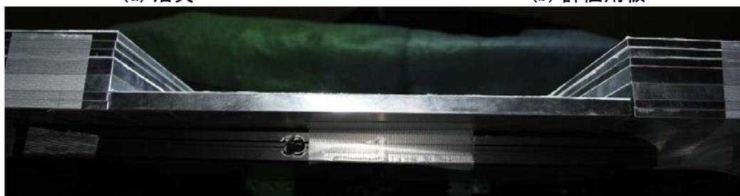
(c) アルミ板の組み合わせにより作成された段差の例
