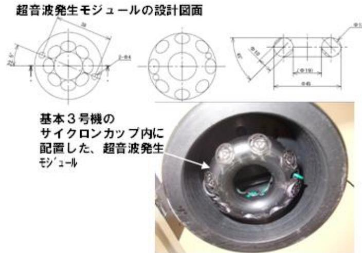
図 2-6 超音波振動子
