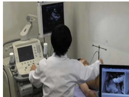
図 11) 光学式センサによるプローブ位置・姿勢計測
