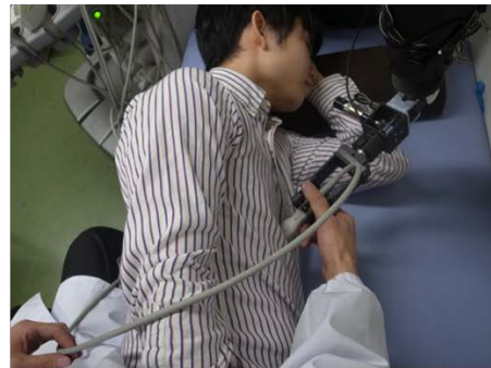
超音波診断一体型・治療補助ロボットによる側臥位診断
