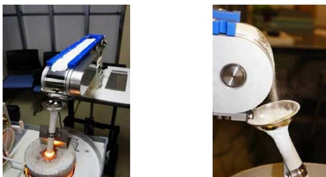
Fig.2-1-6 材料投入装置
