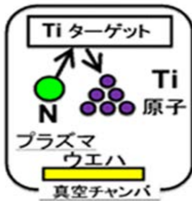
図 2-4-1 接合バリア成膜法の概略図と Ti ターゲットの実物写真
