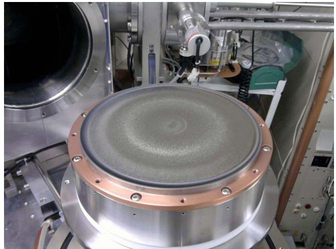
図 2-4-1 接合バリア成膜法の概略図と Ti ターゲットの実物写真
