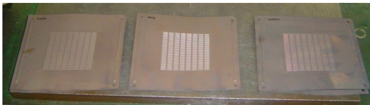
テンパー処理加工 温度：850℃ 保持時間：1時間
