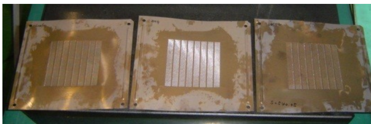
第2プレス成形加工 成形高さ：0.95mm
