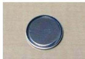
図8-2 試作LIBコイン電池
