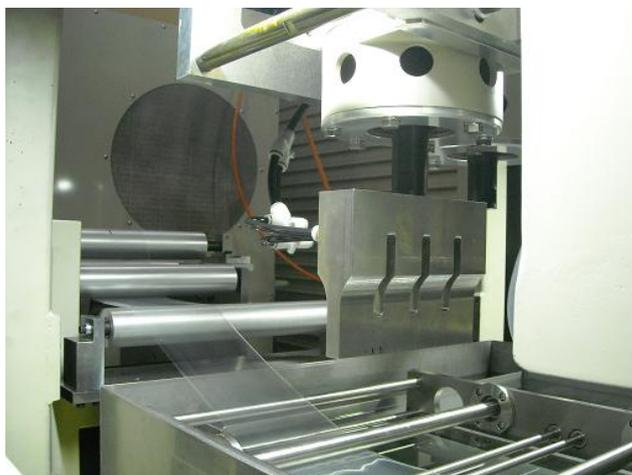
図3-5 バリ取り装置に組込んだ気中キャビテーション用ホーン
