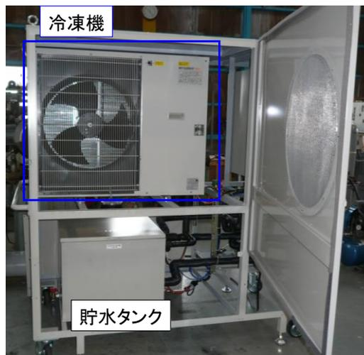
図1-5 加工液温度制御装置と内部のレイアウト
