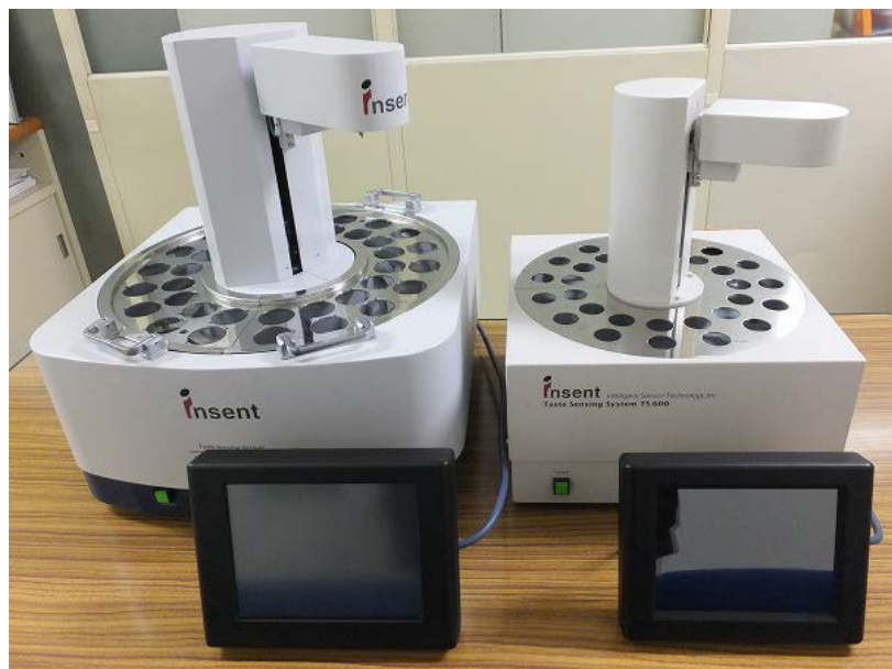
図 3-2-6. 左：従来の味認識装置 右：清酒用味認識装置
