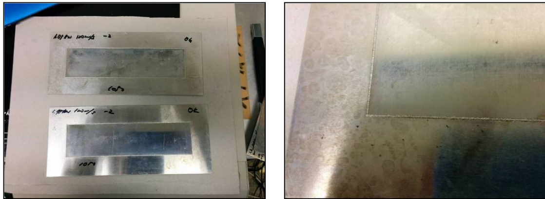
図 25 擬似的なリチウムイオン電池の筐体密閉溶接
