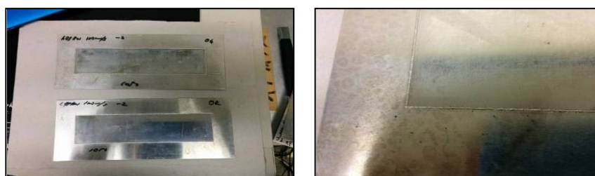
図 6 擬似的な筐体密閉溶接
