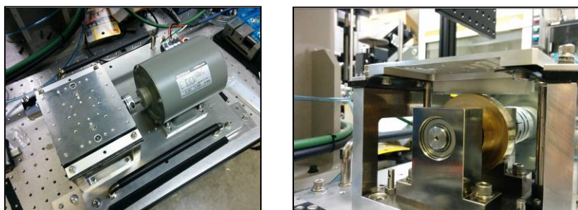
図 22 振動機構（左：試料架台、右：カム機構）
