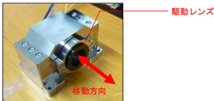
図 13 焦点光軸方向超高速移動機構
