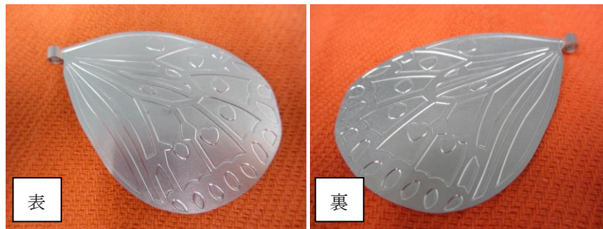
翅の完成品 ※取付ヒンジの一体構造
