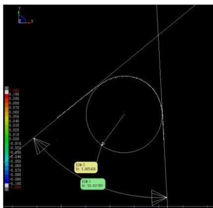
図 2-4-15 機上顕微鏡画像からのバイト先端半径と開き角の導出
