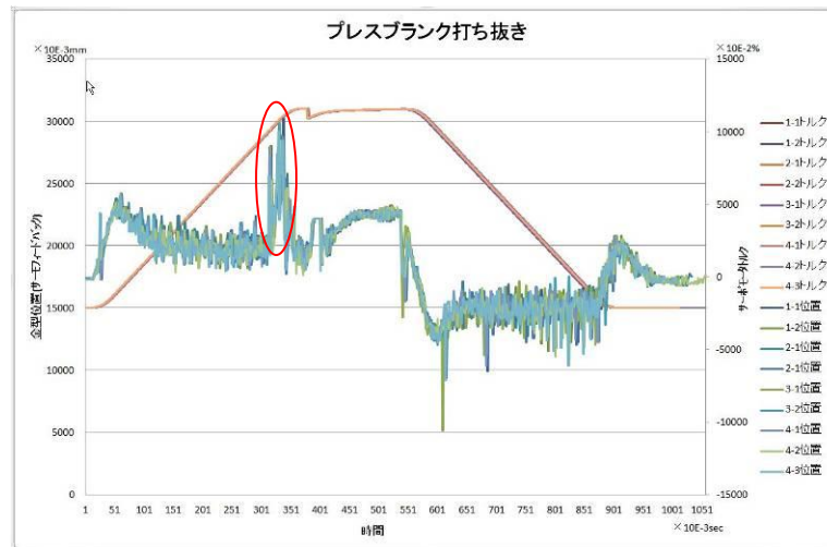
図 2-2-6 プレス機打ち抜き波形
