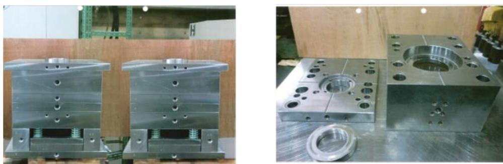
図 3-12 ファンカバー用試作金型
