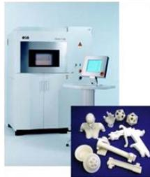
金型3DCADとリンクした光造形品試作体制
