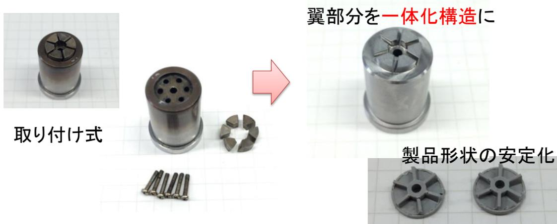
図 4-4 コア分割型から一体化構造の金型への変更
