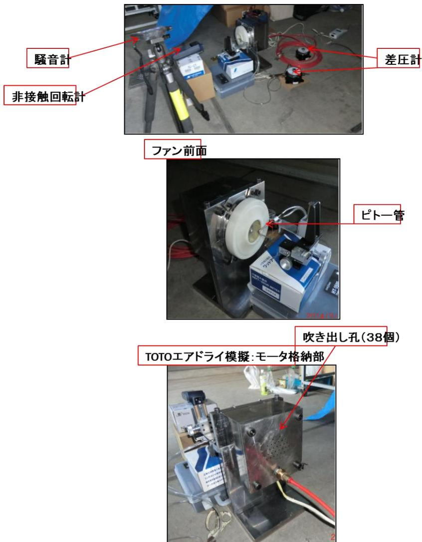
図 3-18 エアータオル模擬装置の写真
