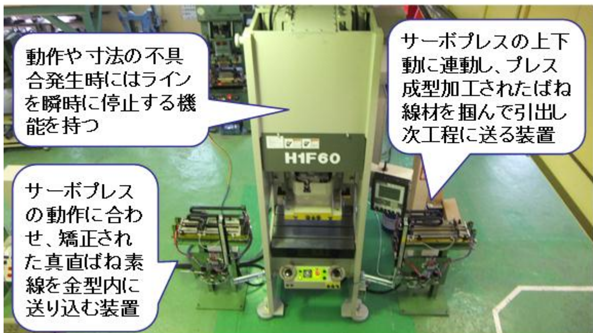
図 2-4-3 ④送り装置・⑤60tサーボプレス・⑦引出し装置
