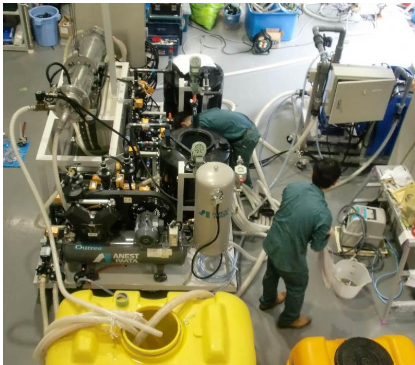
図 2-5-2 横装着式ばね式フィルターの改良（九州大学に設置）
