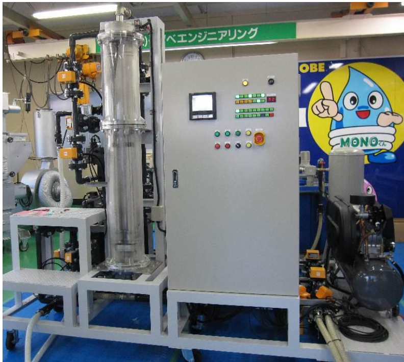
図 2-5-1 縦装着式ばね式フィルターの改良（(株)モノベエンジニアリングに設置）
