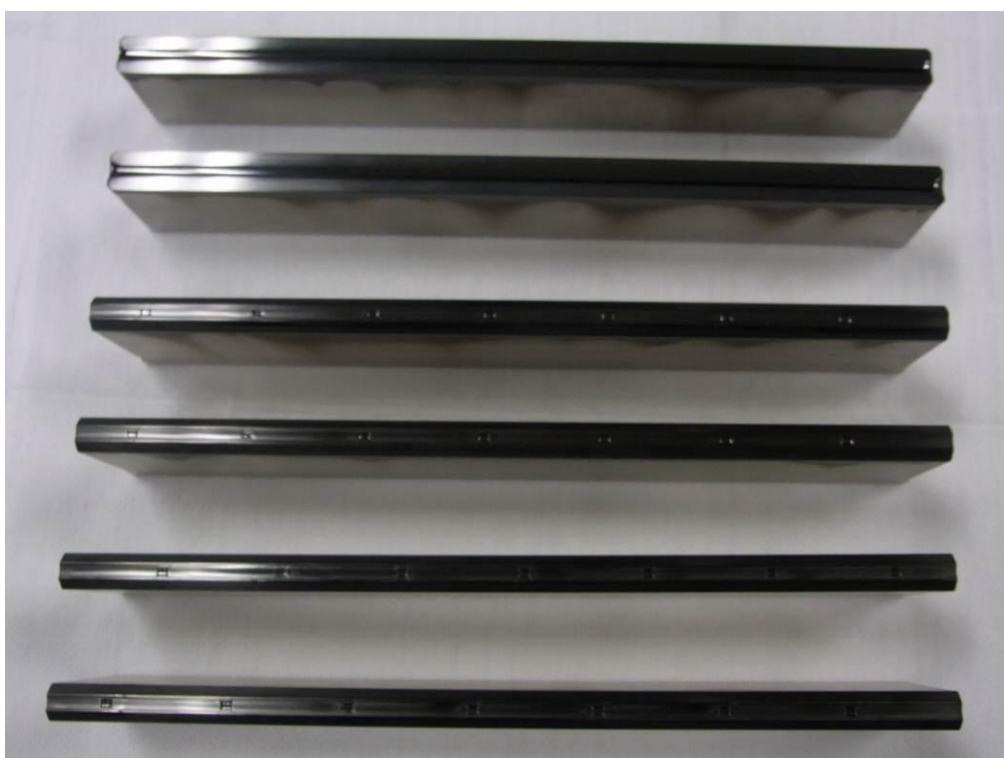
図 2-2-2 金型への DLC 成膜実験
