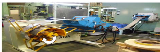
①アンコイルとレベラー装置
