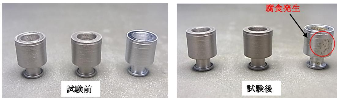
図 2-12 各めっきに於ける耐食性試験前後の模擬製品外観写真
