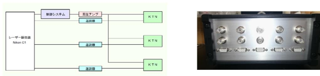
図7 (左) K T Nモジュールの制御システムおよび高圧電源回路(高圧アンプ)を共通化した回路構成。(右) 新たに製作したジャンクションボックス。
