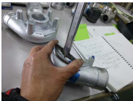
写真 1 3 : ディフューザー段差の計測
