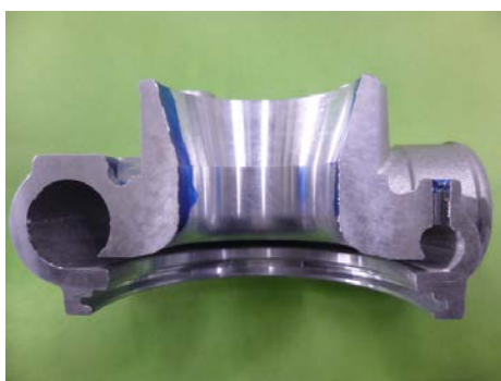
写真 1 1、1 2 : ターボチャージャーの性能を左右するディフューザー段差
