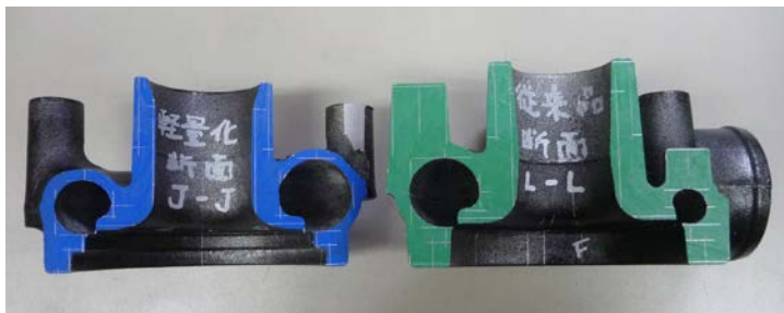
写真 1 4 : 製品肉厚の比較。(左 : H プロセス品、右 : 金型鋳造品)
