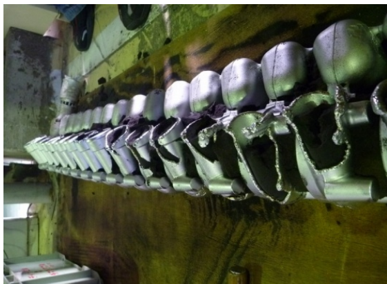
写真 5：H プロセス実験中に発生した湯廻り不良
