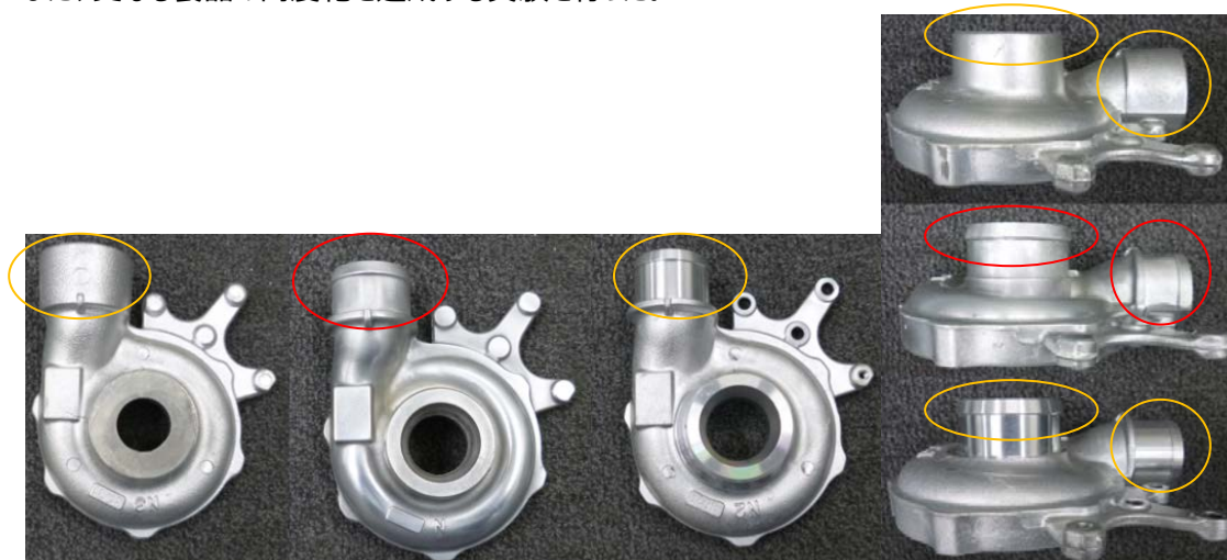
写真 1 6、1 7 ニアネットシェイプモデル 左より金型、Hプロ、加工品 上より金型、Hプロ、加工品
