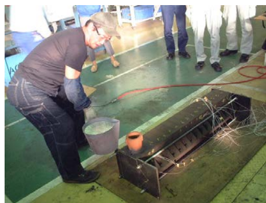
写真 4：H プロセス注湯作業
