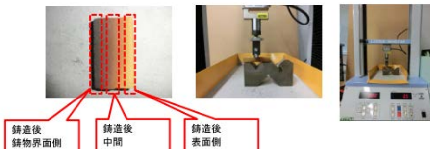
写真 1 9 : シェル砂型の強度試験方法（サンプルの切り出し形状と試験の様子）
