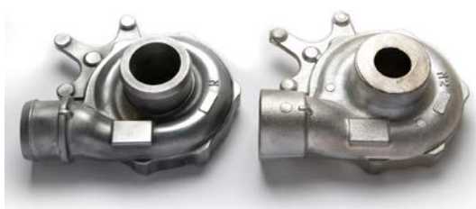
写真 1 5 : 製品重量の比較。(左 : H プロセス品 950g、右 : 金型鋳造品 1,300g)
