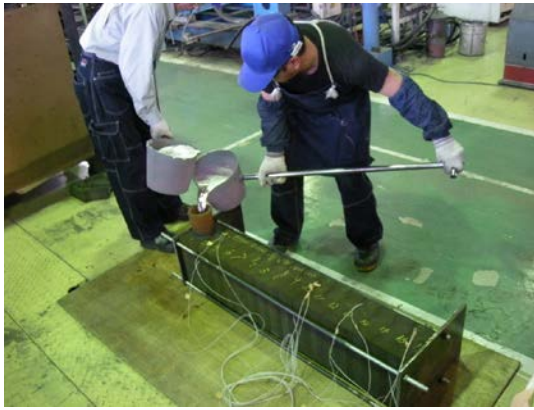
写真 8、9：H プロセス実験で、温度計測をしながら注湯作業を行う様子。
