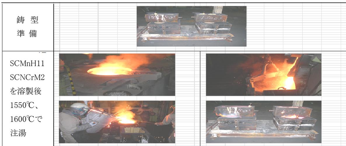
図24 環境部品用超耐摩耗性複合鑄造材ハンマーの同時鑄込み状況
