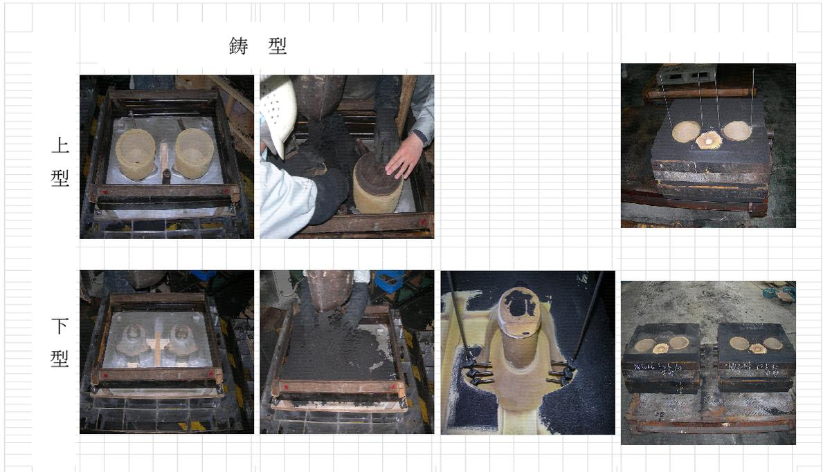
図23 環境部品用超耐摩耗性複合鑄造材ハンマーの開発
