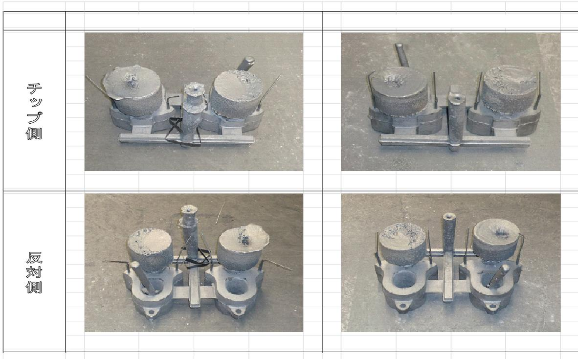
図25 超耐摩耗性複合鋳造材ハンマー同時鋳込み後の外観
