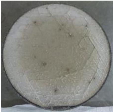
図 2-2 パンケーキ型サセプタを用いて成長した厚膜 GaN
