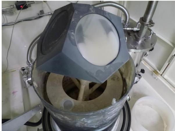
図 2-3 自転機構を持たない 4 インチ 3 枚用バレル型サセプタ
