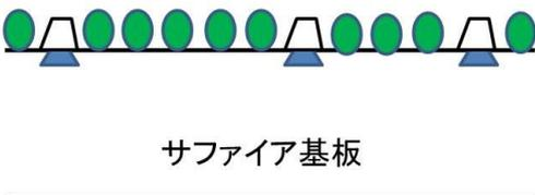
AIN微結晶上にC軸配向したGaN微結晶
