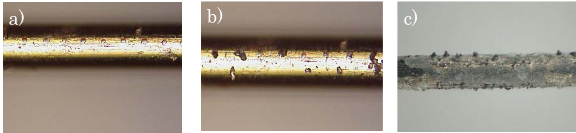
図 2-2-2 導電インク ソーワイヤ上への吐出結果 a) インクのみ、b) 砥粒仮固定、c) 砥粒固定・めっき後
