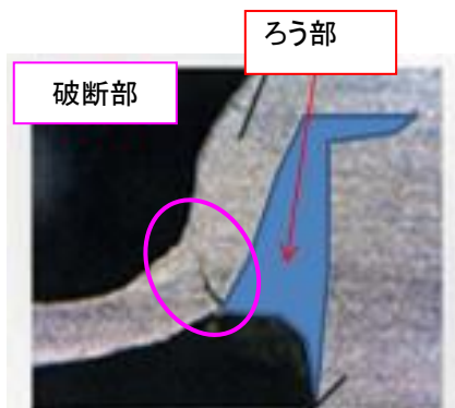
図 2-2-13 破断部断面(第2次試作)
