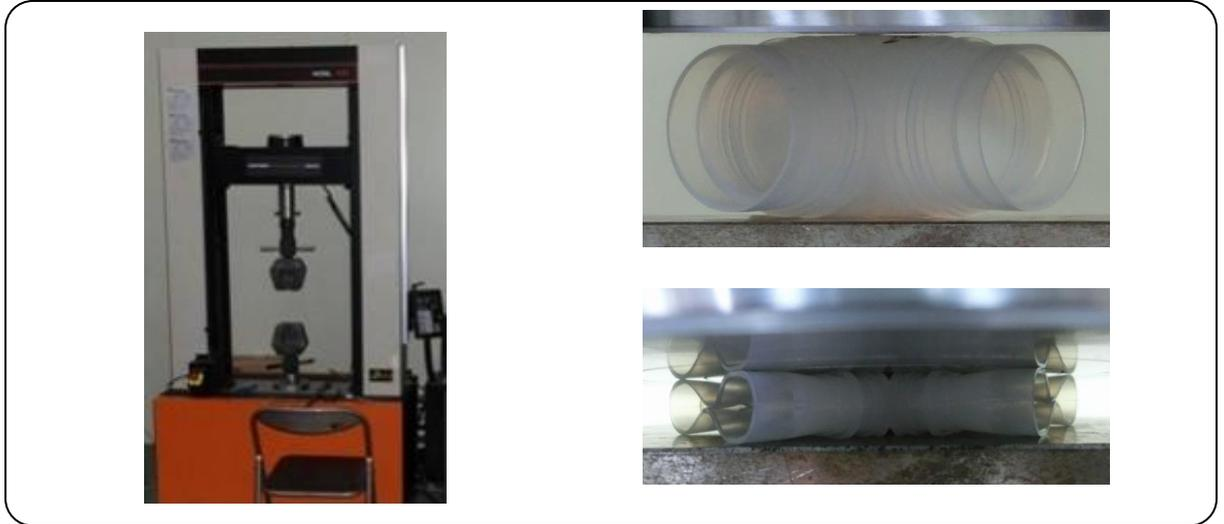
図 2-8 圧縮破壊試験
