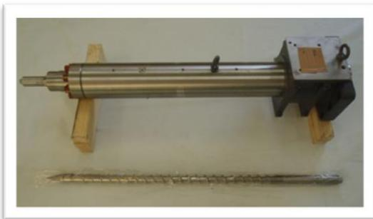
KHV 材で製作した特殊シリンダー、スクリーウは充填材入素材にも対応可能。
