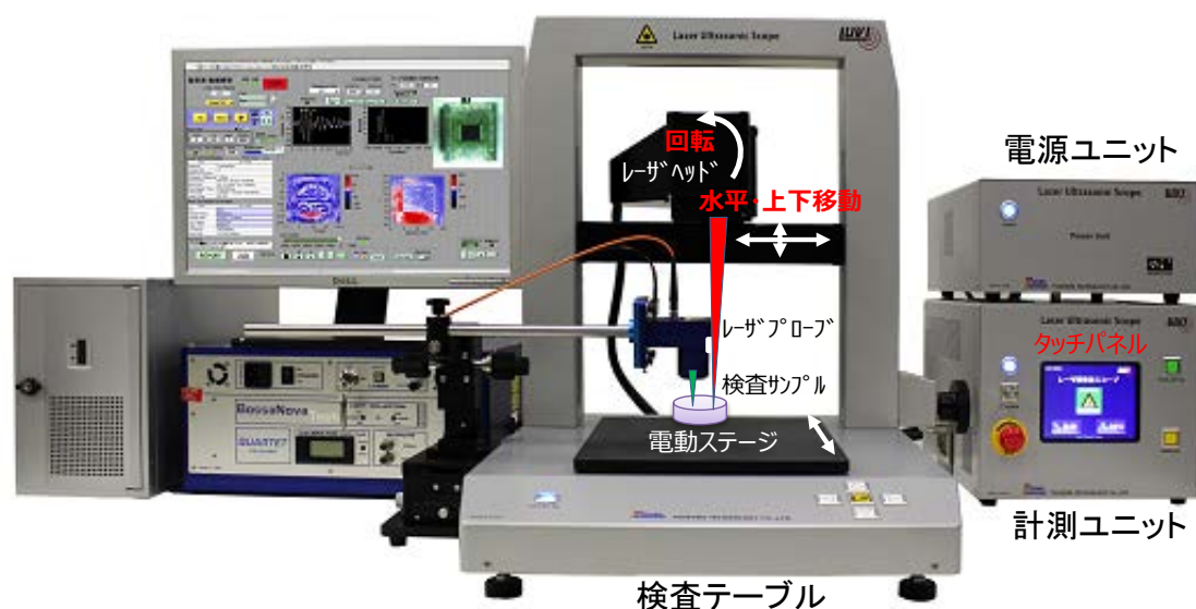
図 2.1 開発したレーザ超音波可視化検査装置（レーザ超音波スコープ）
