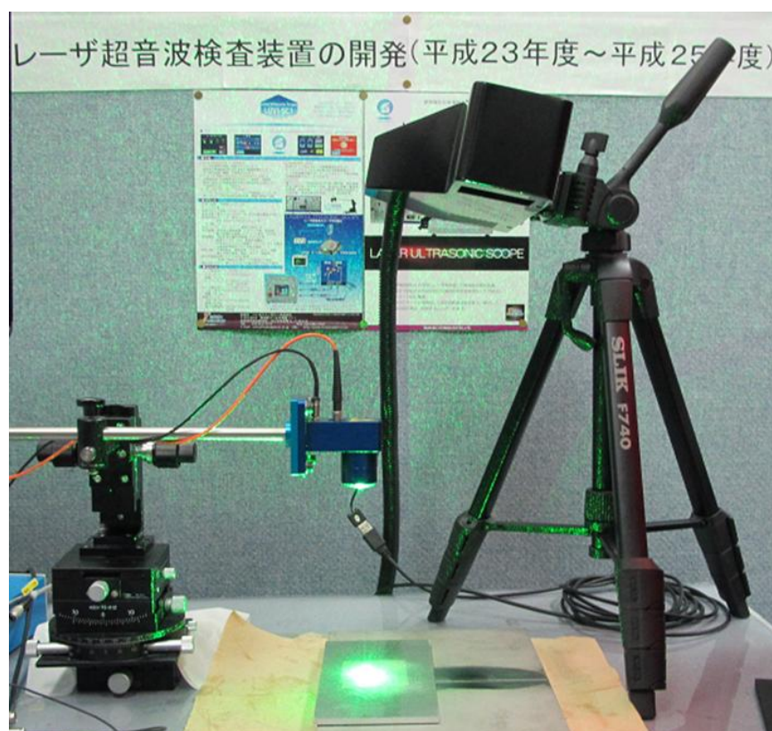
図 2.2 レーザヘッドを三脚に搭載した場合の使用例
