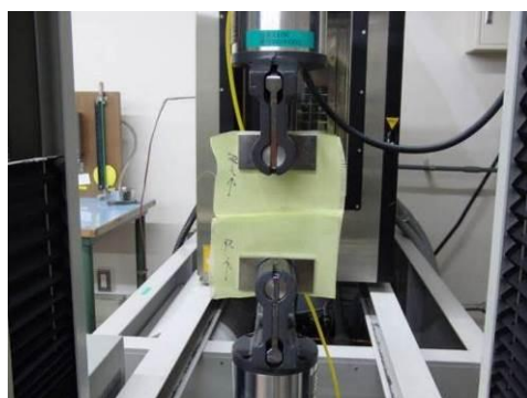
図4-6 滑脱試験の様子
