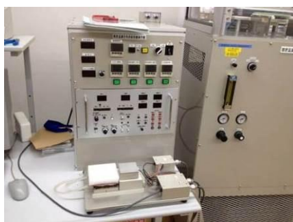
図4-8 接触温冷感性測定装置
