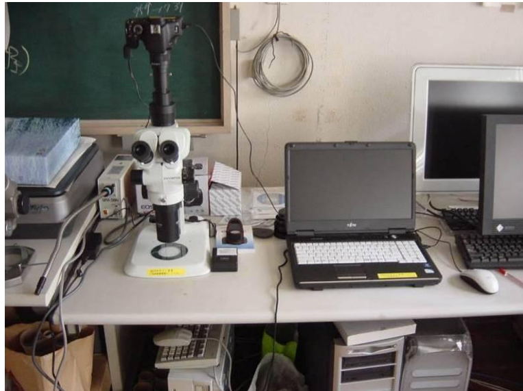
図4-22 実体顕微鏡測定システム
