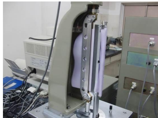
図4-12 KES曲げ試験の様子
