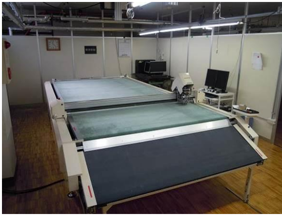
設置したコンピューターパターン展開カッティングシステムとパラメーター画面
