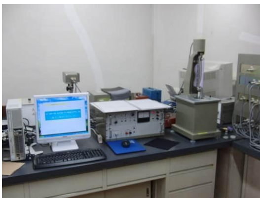
図4-12 KES曲げ試験の様子
