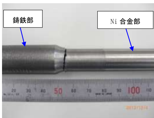
写真2-2-2-2 鋳ぐるみ接合試験片(引張応力:278.8MPa)
