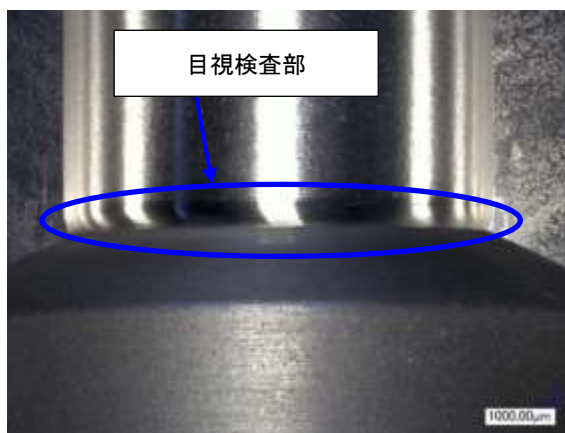
写真 2-3-3-1 Ni合金接合部の目視検査
