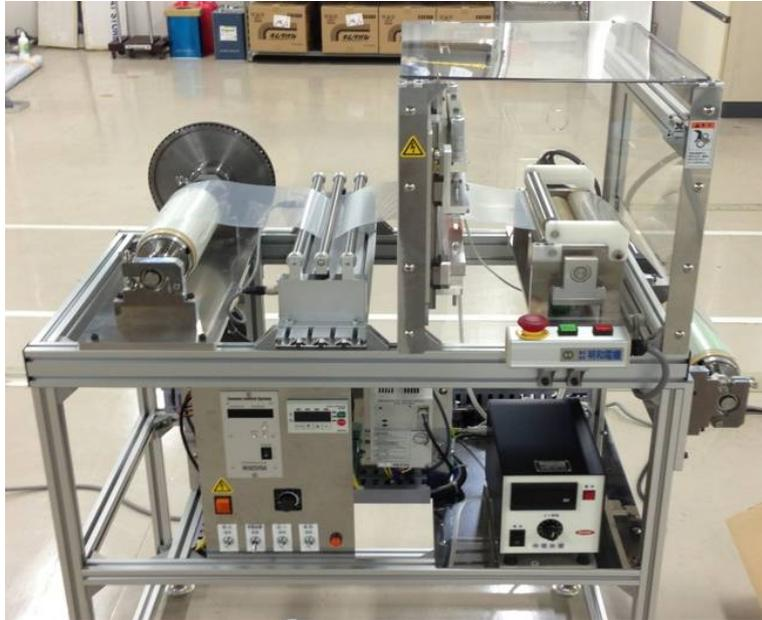
第 2.3.2-1 図 製作したロールトゥロール分極処理試作機装置写真。
