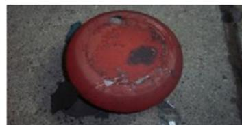
【図 3-5】 アップセット鍛造によるディスクの作成
