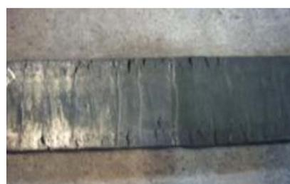
【図 3-7】 割れの発生した鍛造材
