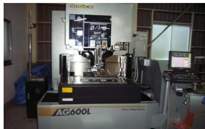
【図 3-12】 導入したフライス盤(左)とワイヤーカット放電加工機(右)
