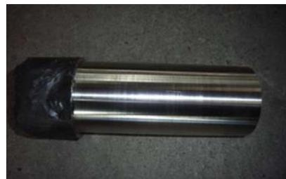
【図 3-4】 旋盤加工後の鍛造材
