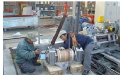
【図 3-8】圧延ロール交換作業
