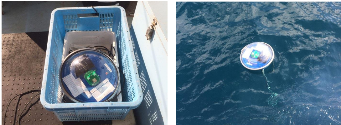
図 2-2-33 投入前の多機能漂流ブイ(左)と投入後の多機能漂流ブイ(右)
