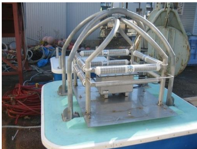
図 2-2-16 太陽電池を装備した定置網監視装置
