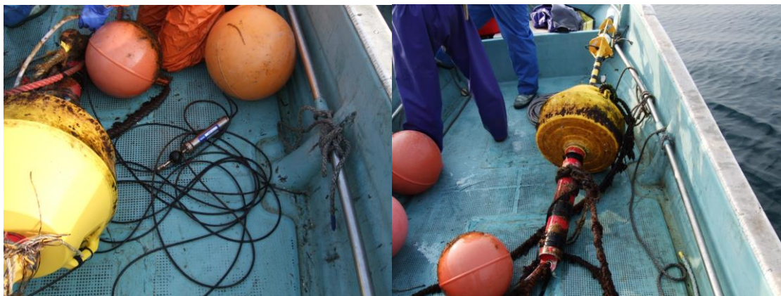
図 2-2-8 銭亀沢漁業協同組合 陸揚げ時のロープ及びセンサーケーブル
