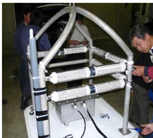
図 2-2-30 球状太陽光パネル設置
