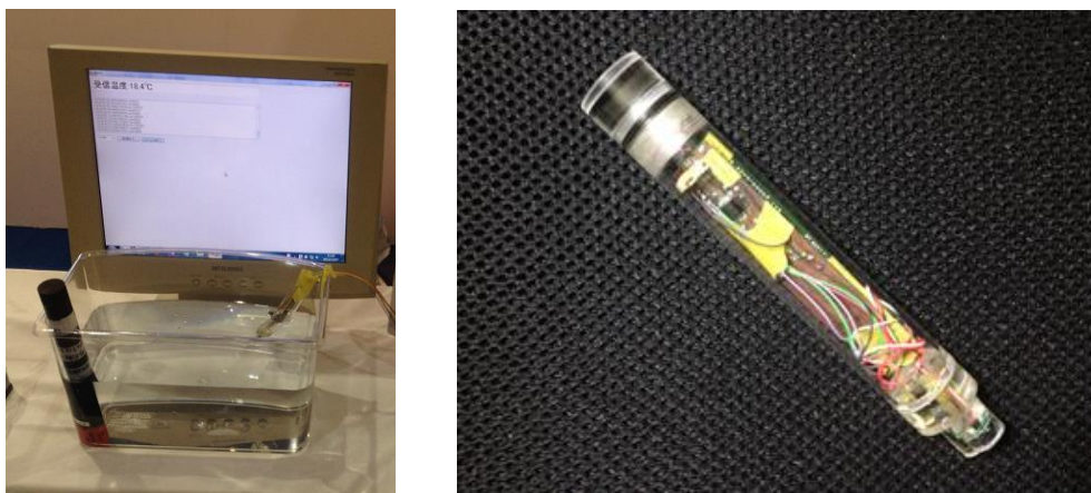
図 2-3-2 左:水中による受信デモ展示の様子/右:展示に使用した受信機能検証用試作機
