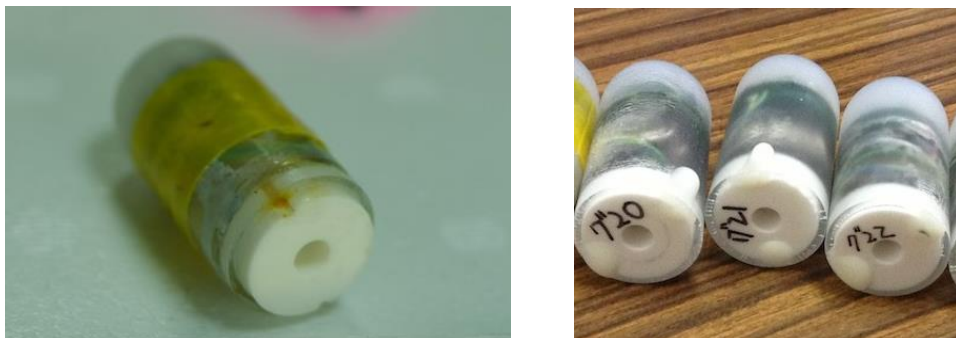
図 2-4-4 左:浸水した深度・水温ロガー
