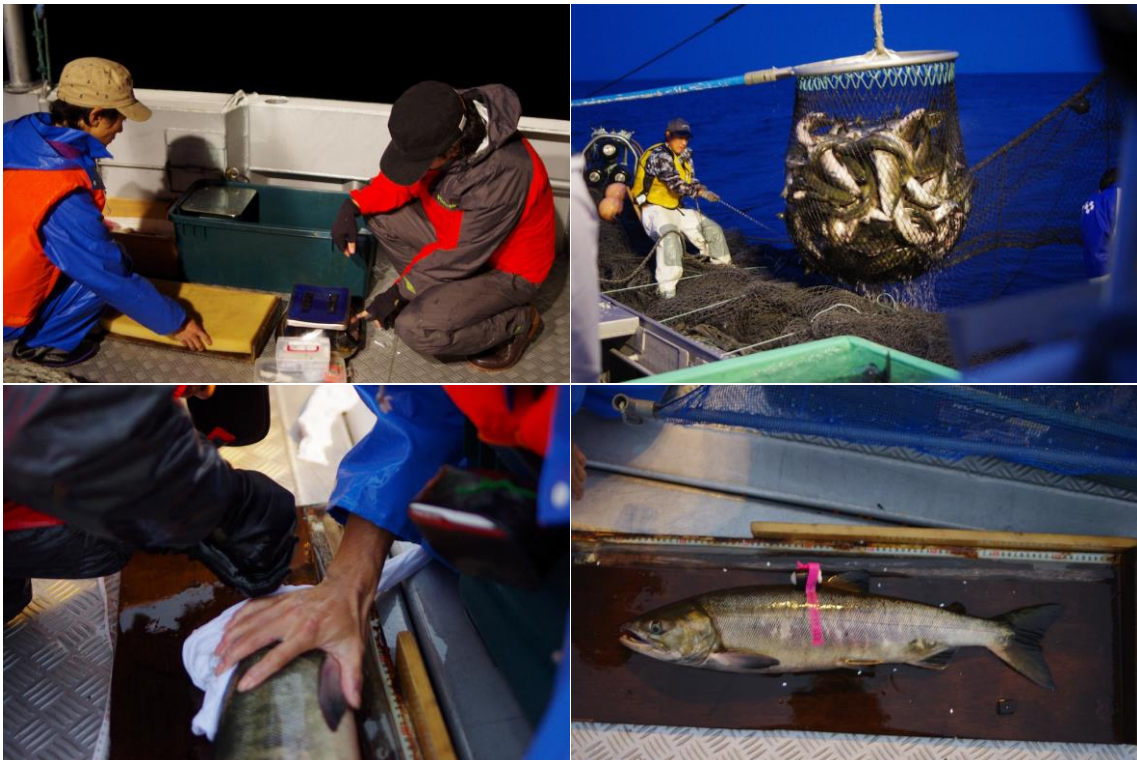
図 2-4-3 ウトロ沿岸海域を例としたシロザケ検証の様子(左上:ロガー装着準備中、右上:定置網からのシロザケ引き上げの様子、左下ロガー装着中、右下:ロガーを装着したシロザケ)
