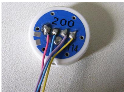
図 2-1-8 左:昨年度使用したセラミック圧力センサ外観/右:内部構造
