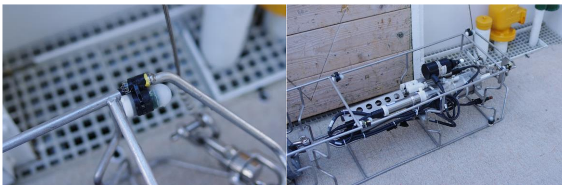
図 2-4-1 CTDに固定されたデータロガー（左：CTDに固定されたデータロガー、右：CTDと5個のデータロガー）
