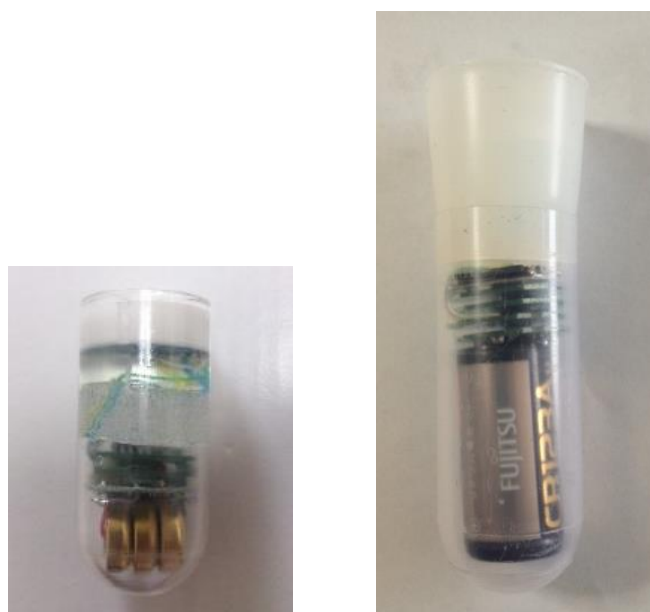
図 2-1-2 左:DT 型ロガー開発機/右:DTA 型ロガー開発機
