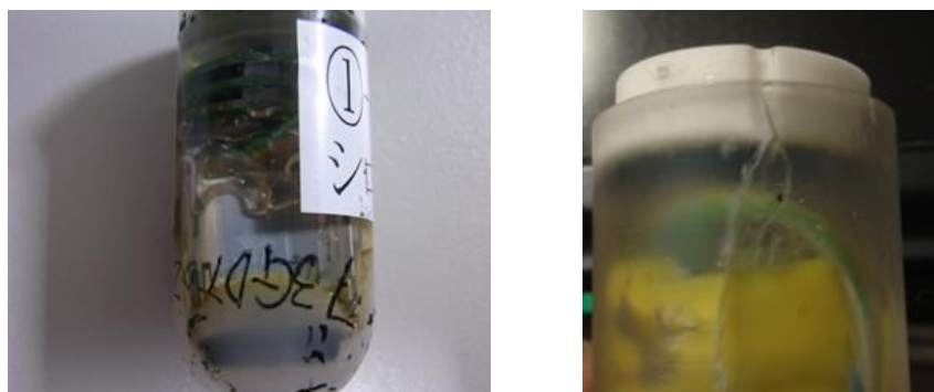
図 2-1-5 左:クラックが入った個体/右:気泡から漏水し電池から液漏れしている個体
