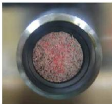
バンドル端面(T の字を撮像した様子)
