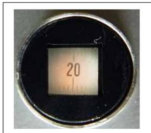
図 12 近赤外カメラ用バンドルの画像伝送 (スケールの“20mm”表示を撮像)
