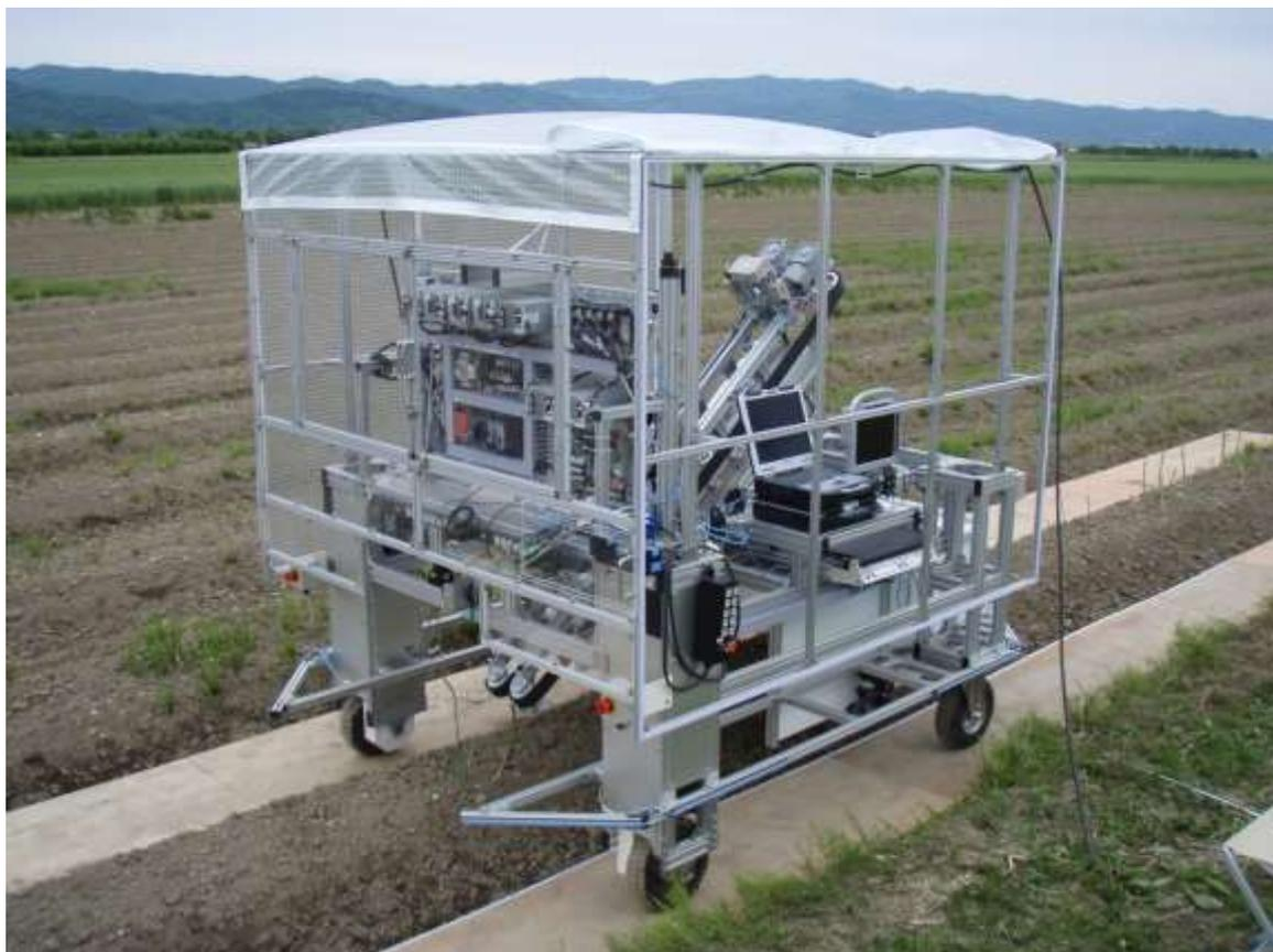
図 1: ノンストップで走行しながら収穫可能なアスパラガス自動収穫機
