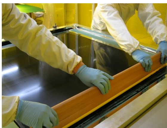
図12 手作業によるスクリーン印刷作業
