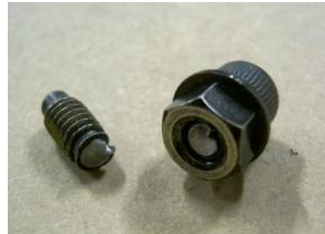
図6-5 破断したボルト
