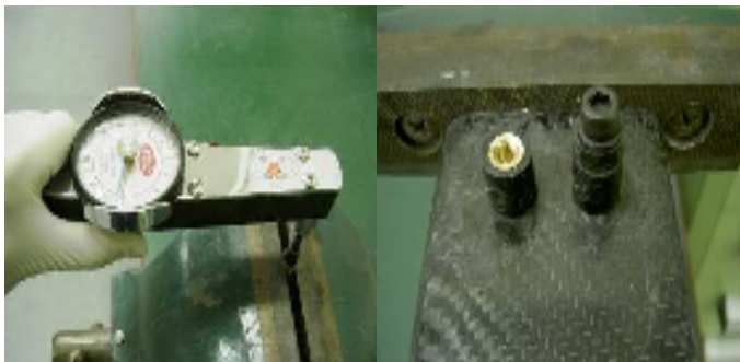
図6-4 締め付け破壊試験
