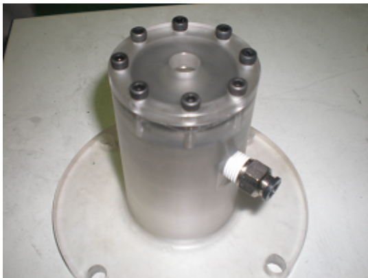
図 2-1-1.8 アクリル製シリンダの写真 (内部にバルブを組み込み)
