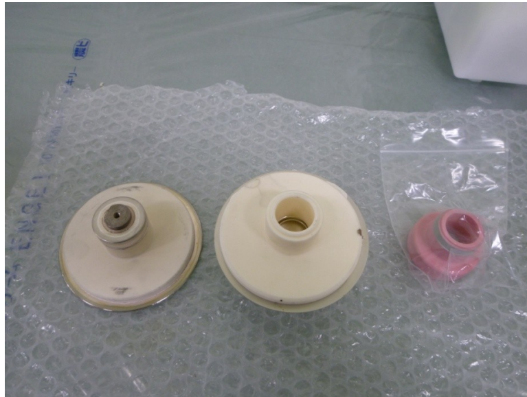
図2-3-12. 各種小型X線管 左(2個): 平型X線管 右(ピンク色): 超小型X線管
