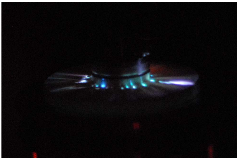
図2-1-10. 平型 X 線管の放電の様子。
