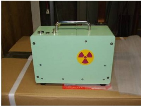
CNX-X線管と電源をケースに入れた可搬型(ポータブル)X線源
