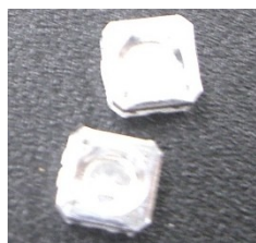
外観 パッケージ内部拡大 図2.5.1-4 試作完成した5mm□LEDパッケージ
