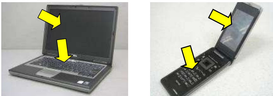
図1-1-1: バックライトが組み込まれている電子機器とバックライトの場所
