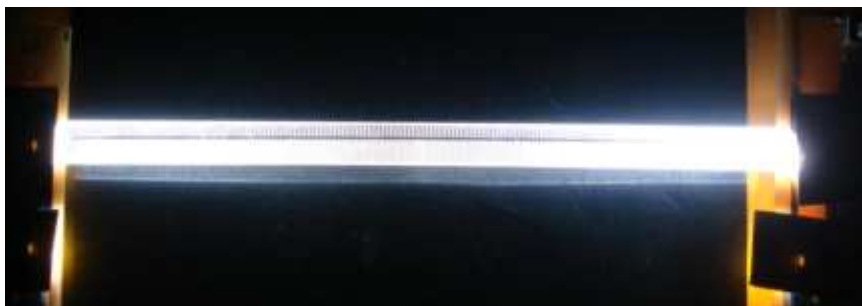
図 2-3-9: 試作開発した導光板の発光状態
