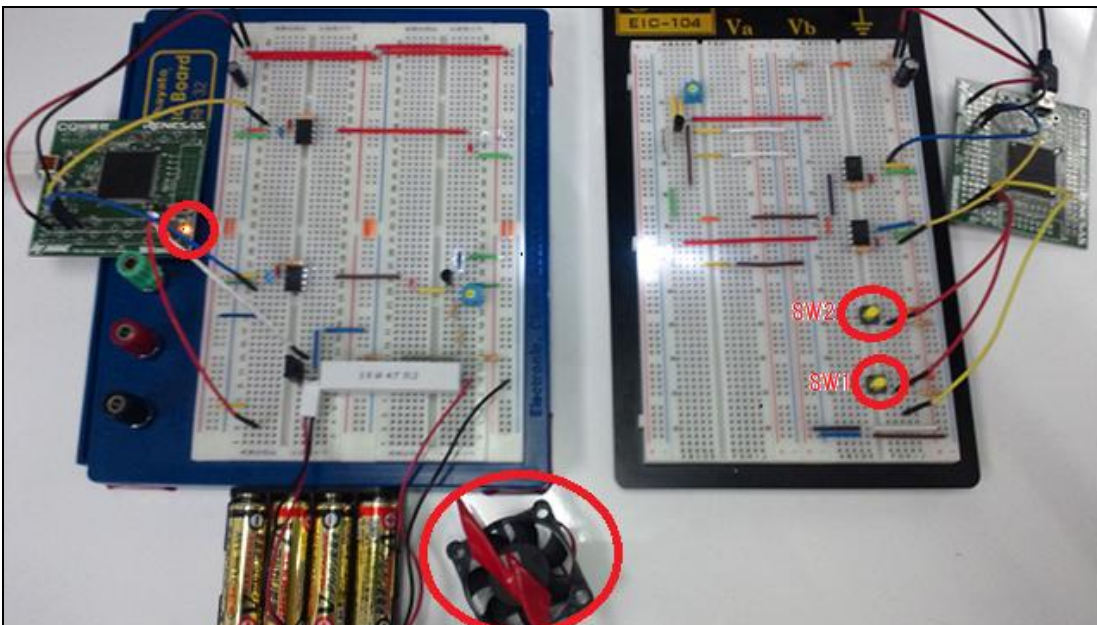
図 2-5-9. ファン停止信号を送受信した様子
