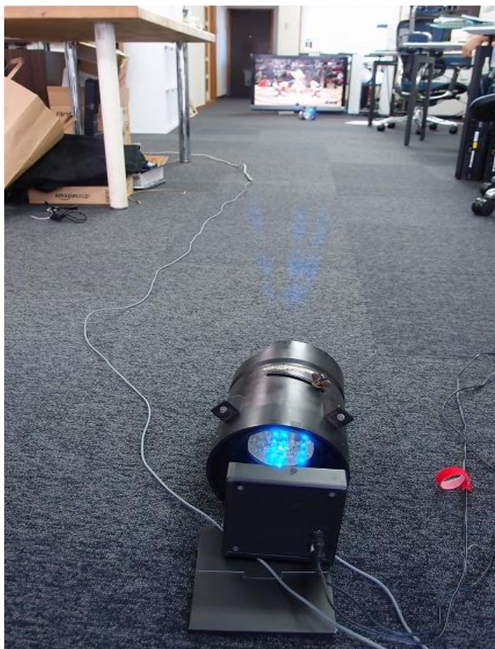
図 2-6-22. レンズを用いた光伝送実験の様子(発光部)
