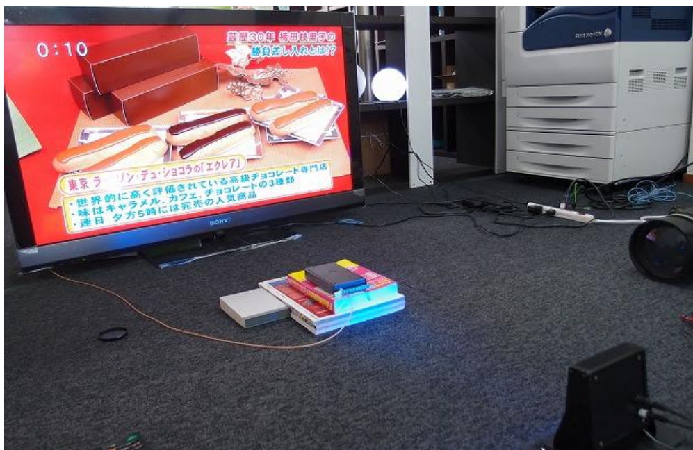
図 2-6-14. 受光-発光間距離 50cm でのテレビ映像受信風景
