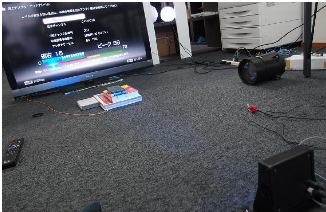
図 2-6-15. 受光-発光間距離を 1m にした時の受信強度観測実験風景
