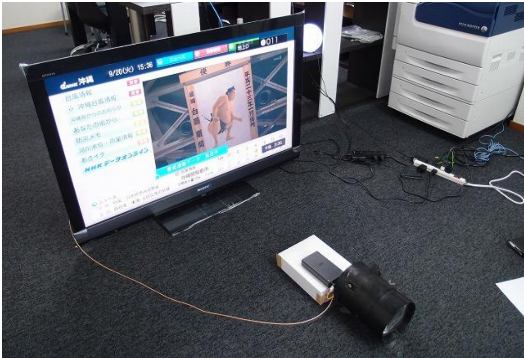
図 2-6-25. レンズを用いた光伝送実験でのテレビ映像受信風景
