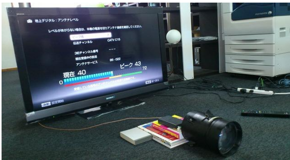
図 2-6-31. 一灯タイプの発光器を用いた光伝送実験の様子(受光部)
