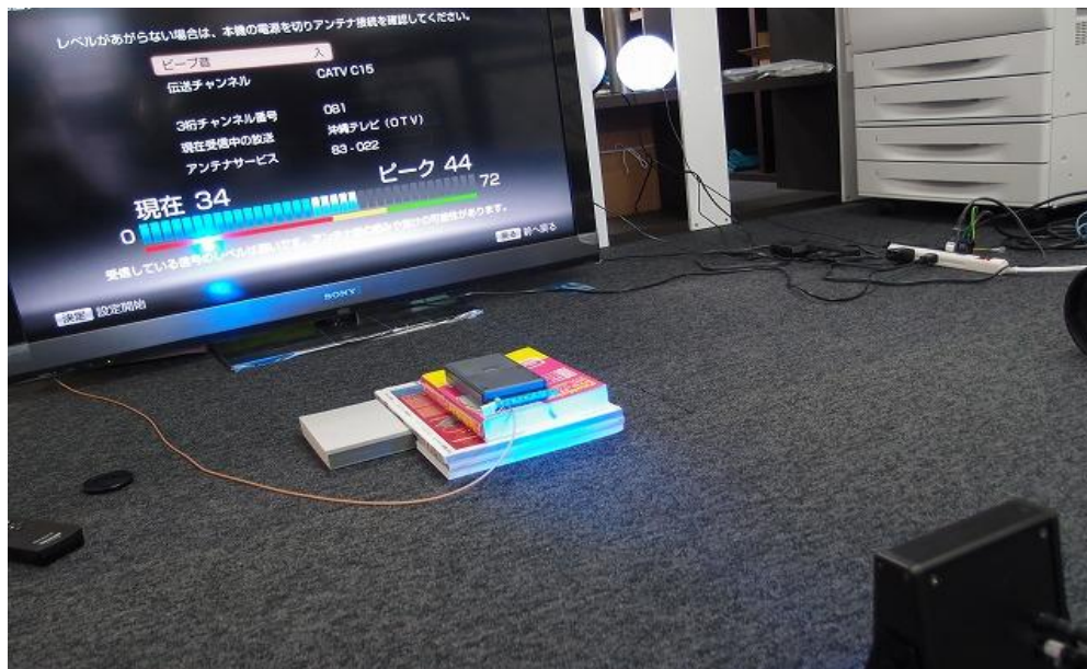
図 2-6-13. 受光-発光間距離を 50cm にした時の受信強度観測実験風景
