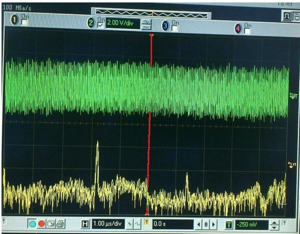
図 2-6-20. 発光-受光間距離 50 [cm] の時の波形と周波数スペクトル (周波数スペクトルのレンジ：中心線(赤線)25 [MHz], 5 [MHz]/div) (地上デジタル放送波の周波数：22.143 [MHz] 中心に 6 [MHz] の帯域)
