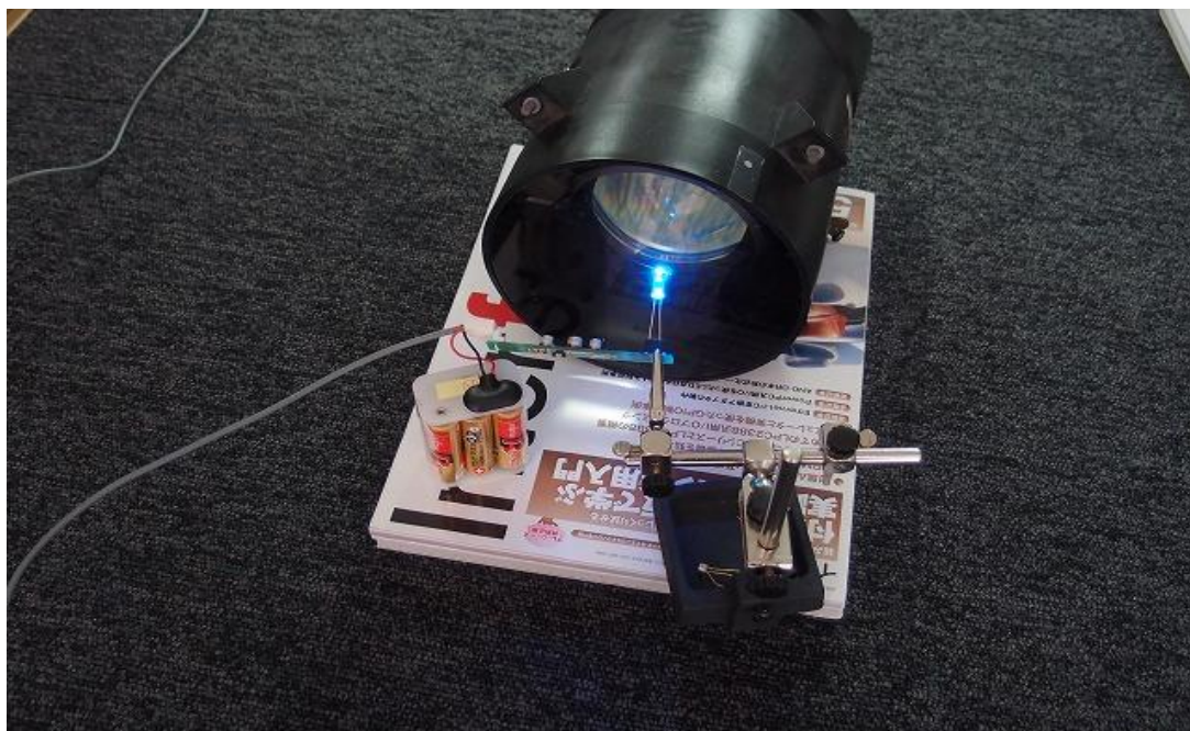
図 2-6-30. 一灯タイプの発光器を用いた光伝送実験の様子(発光部)
