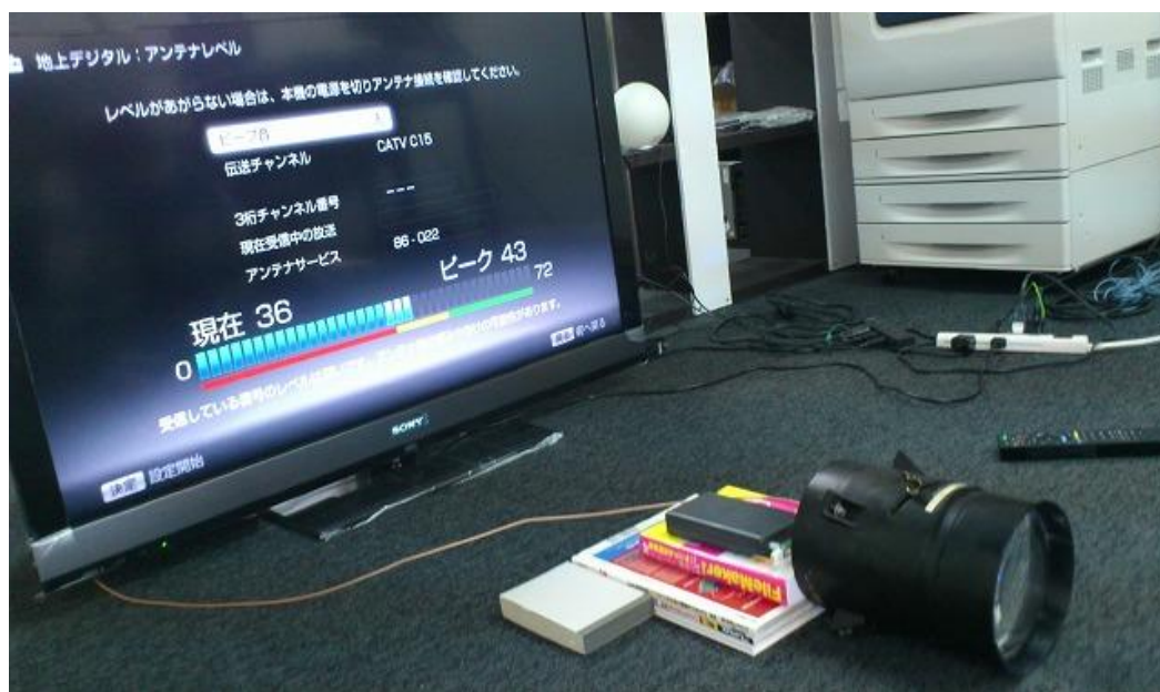
図 2-6-23. レンズを用いた光伝送実験の様子(受光部)
