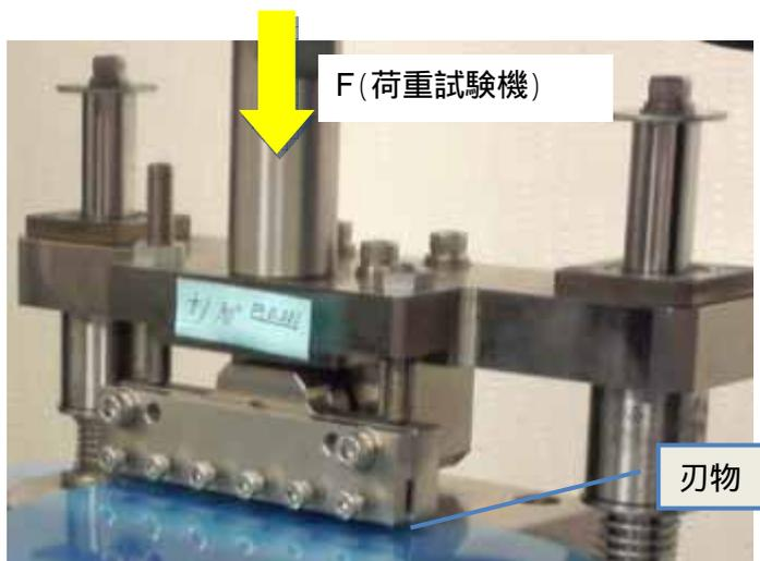
図 2.3.3 (9) 破断状況 (へき開加工状況)
