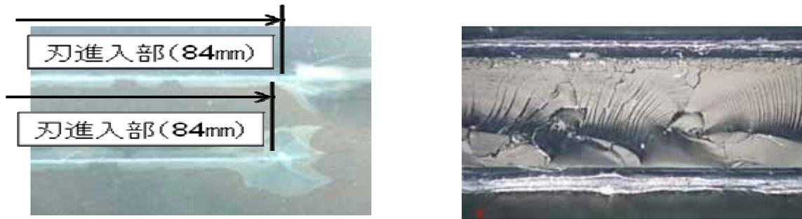
図 2.3.3(11) 刃先角度 105° のパネル上から見た外観（左側）とへき開加工断面の品質（右側）
