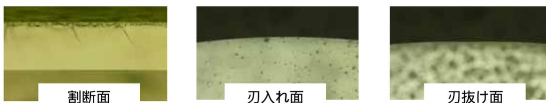
図 2.1.3.(2).a 丸刃(直径 6mm) 40 度左右対称両刃の切断面(刃物条件 )
