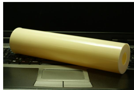
写真9 修正後の試作金型での成形品 （肉厚 1mm）の外観
